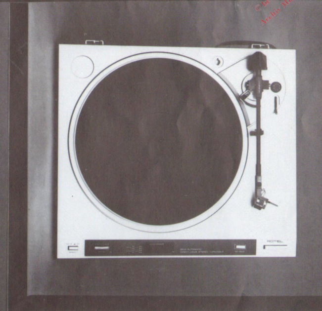
R O T E L R P 8 6 0 Vollautomatischer Plattenspieler mit Riemenantrieb, FG-Gleichstrom-Servomotor, Detektorschaltung mit Frequenzgenerator für stabile Drehzahlen, Geschwindigkeitsfeinregulierung, ölgedämpfter Tonarmlift, beleuchtetes Stroboskopfenster, Magnetsystem, Abdeckhaube.
